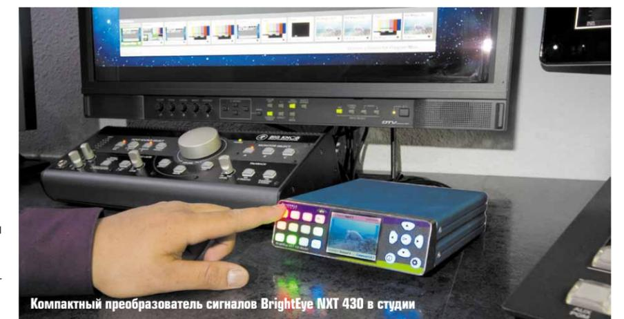
Компактный преобразователь сигналов BrightEye NXT 430 в студии
